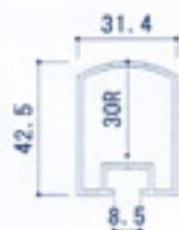
階段ルーバー (B-1136)
